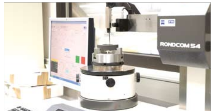
Messung der Formtoleranzen an Einstellringen Measuring of form tolerances on adjusting rings
